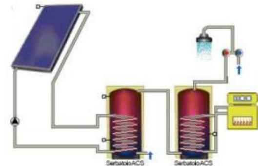
SCHEMA PRODUZIONE ACQUA CALDA SANITARIA
